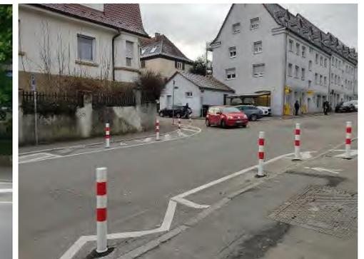
Vorgezogene Seitenräume und Verschmälerung überdimensionierter Fahrbahnen und Kreuzungsbereiche zur Verkehrsberuhigung (Quelle: eigene Aufnahmen)
