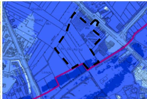
Abbildung 5: Ausschnitt aus der Hochwassergefahrenkarte (HG extrem) (© Bezirksregierung Düsseldorf)
