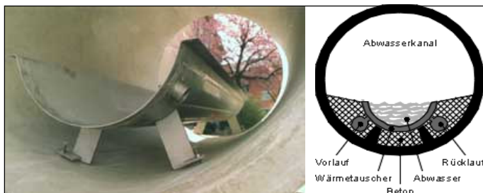
Abb. 19: Rinnenwärmetauscher für Kanäle mit Kreisprofil
