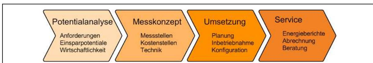
Abbildung 25: Vorgehen zur Einführung des Energiemonitorings [eigene Darstellung]
