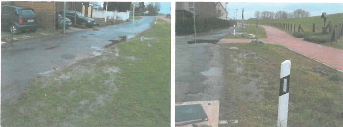
Neben den oberflächennahen Vernässungen im nordöstlichen Bereich der Untersuchungsfläche waren die gewachsenen Böden im südwestlichen Bereich in KRB 14 am Bohrtag (27.02.2015) stark durchfeuchtet und in KRB 15 stark vernässt (Anlage 2.1).
